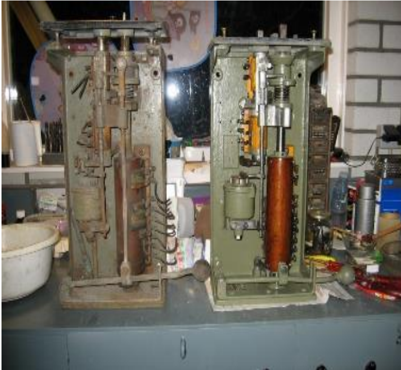
Linker foto: de twee rijcontrollers van de 252; de rechter is al bijna klaar, de linker moet nog gedaan worden. Rechterfoto: de rijcontroller gereed voor inbouw. Rechtsonder is het dodemanspedaal zichtbaar.
