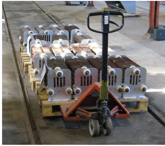
Links: schoonmaken van de rijweerstand. Rechts: De doorgemeten rijweerstand, bijna gereed voor montage.
