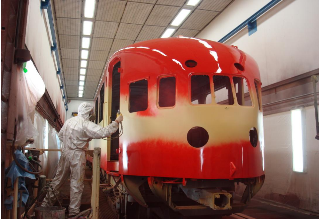
De BCK in de spuithal; als eerste worden de rode biezen gespoten.
