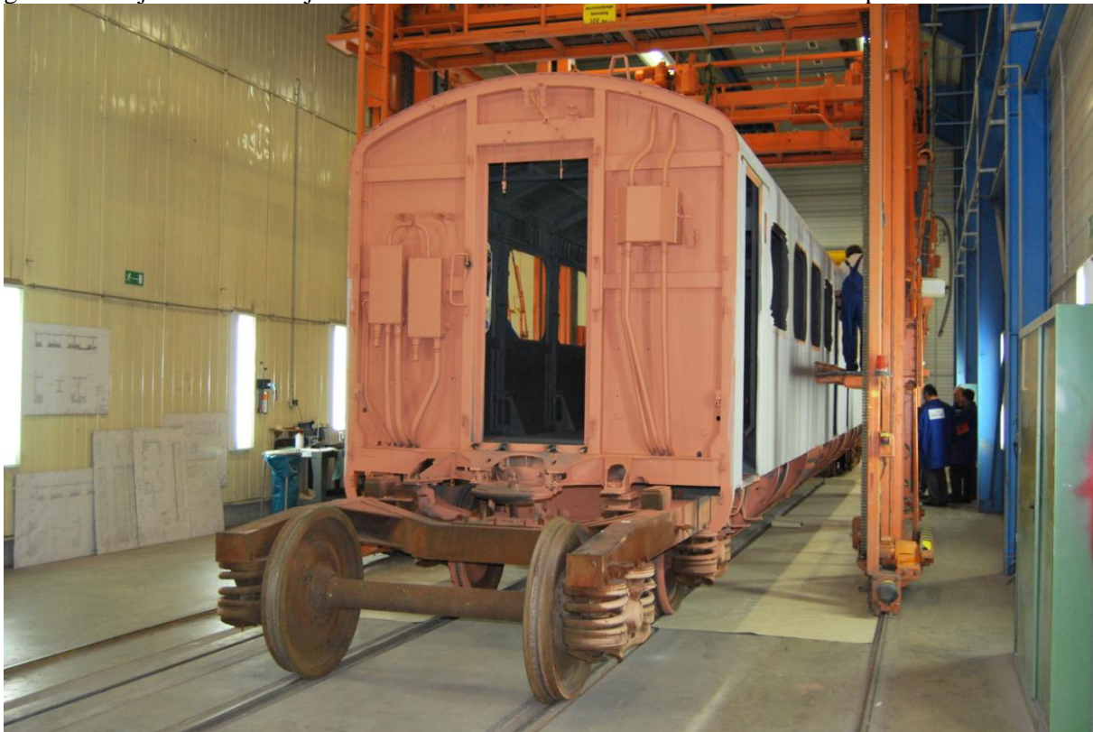
De BCK-bak in de grondverf in de spuithal waar de tweecomponentenplamuur wordt opgebracht.
